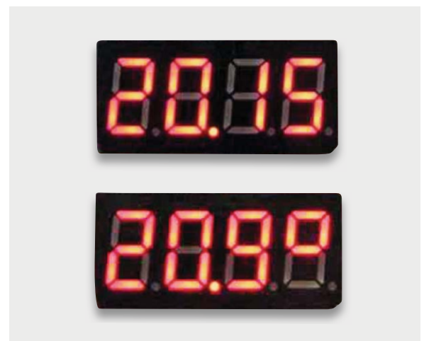
Bild 6: Die 4x7-Segment-LED-Anzeige als Uhrendisplay oder zur Anzeige von Temperaturen
