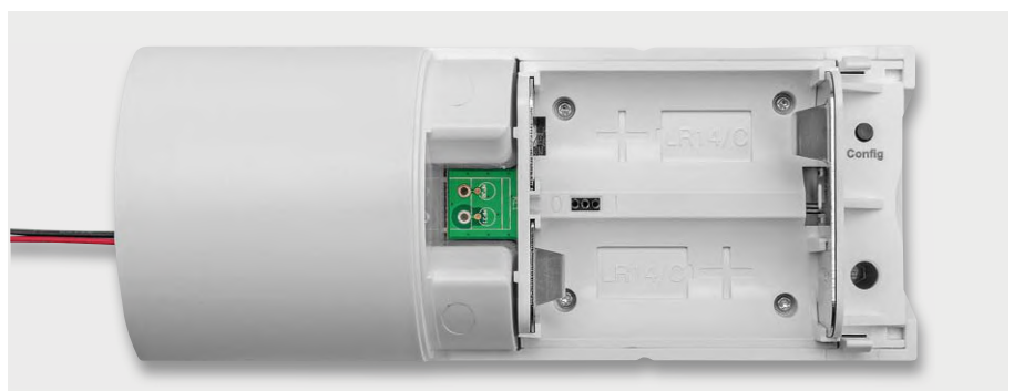
Bild 12: Die abisolierten Leitungsenden des Lautsprecherkabels sind, wie hier gezeigt, auf der Platine zu verlöten und mit Heißkleber o. ä. zu verkleben.
