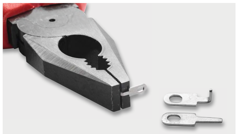
Bild 7: So erfolgt das Biegen der Lötösen.
