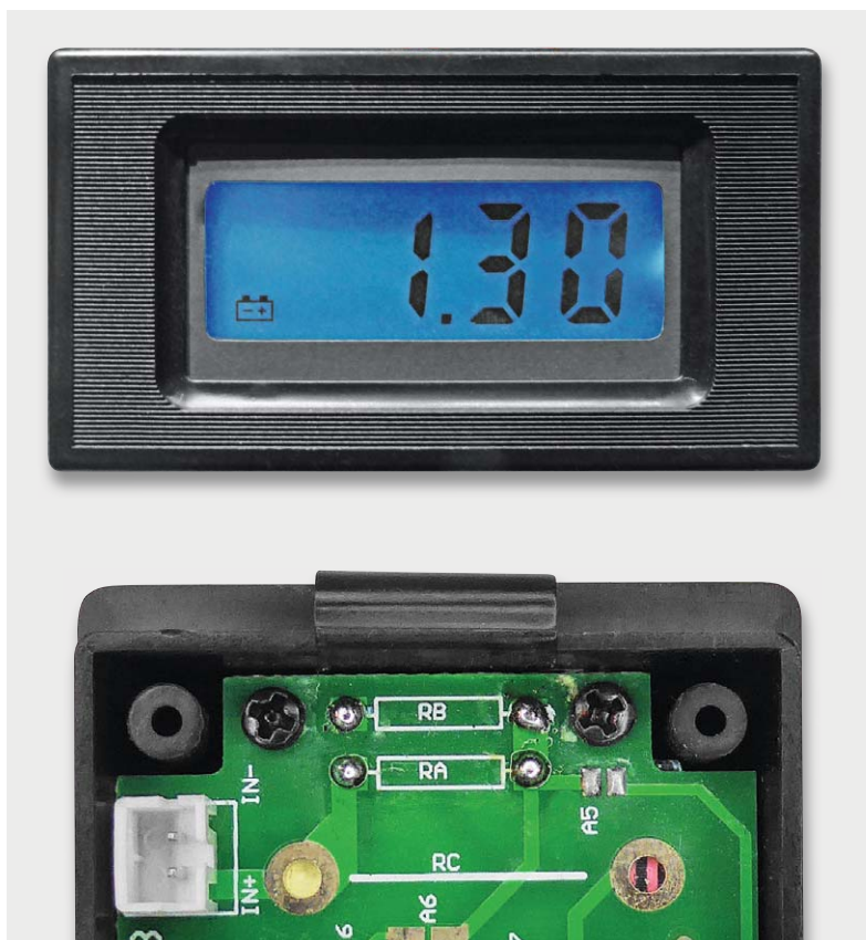
Bild 8: Preiswerte Panelmeter wie das hier gezeigte, weitverbreitete PM435 können als Anzeige eingesetzt werden. Sie sind über Spannungsteilerwiderstände (RA/RB) bzw. Shunts (RC) für die Anzeigaufgabe konfigurierbar.
