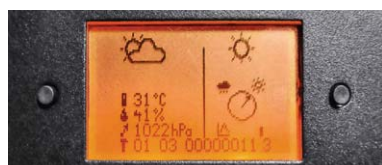
Bild 3: Intelligent gelöste Konfiguration ohne Programmierstress mit zwei Tasten und unterer Displayzeile
