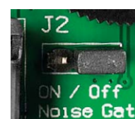
Bild 3: Der Jumper für das Noise-Gate
